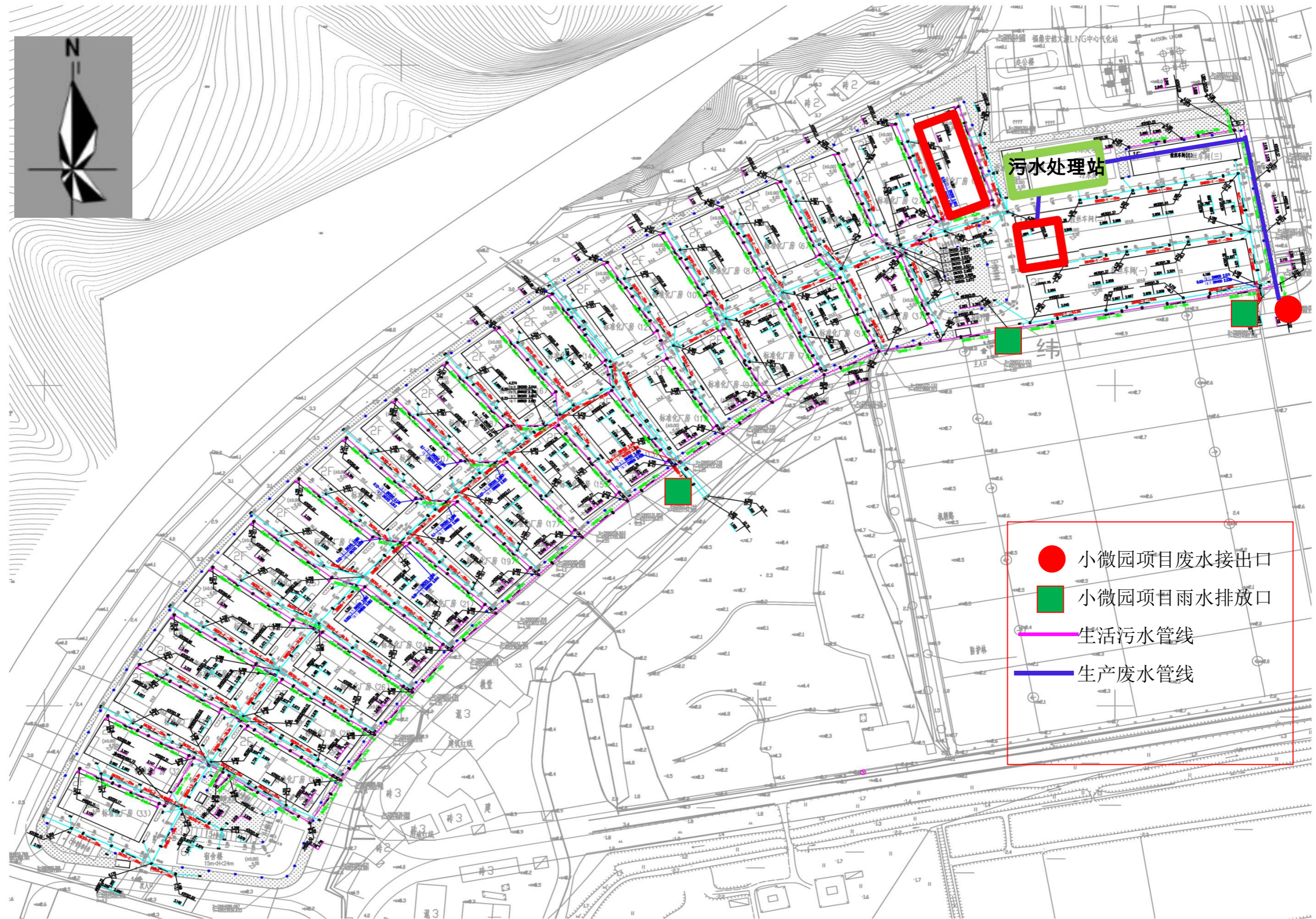
附图1—小微园项目雨污水管网图
