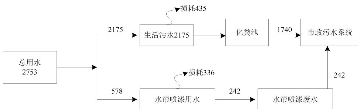
图 4.5-2 项目水平衡图（单位：m<sup>3</sup>/a）
