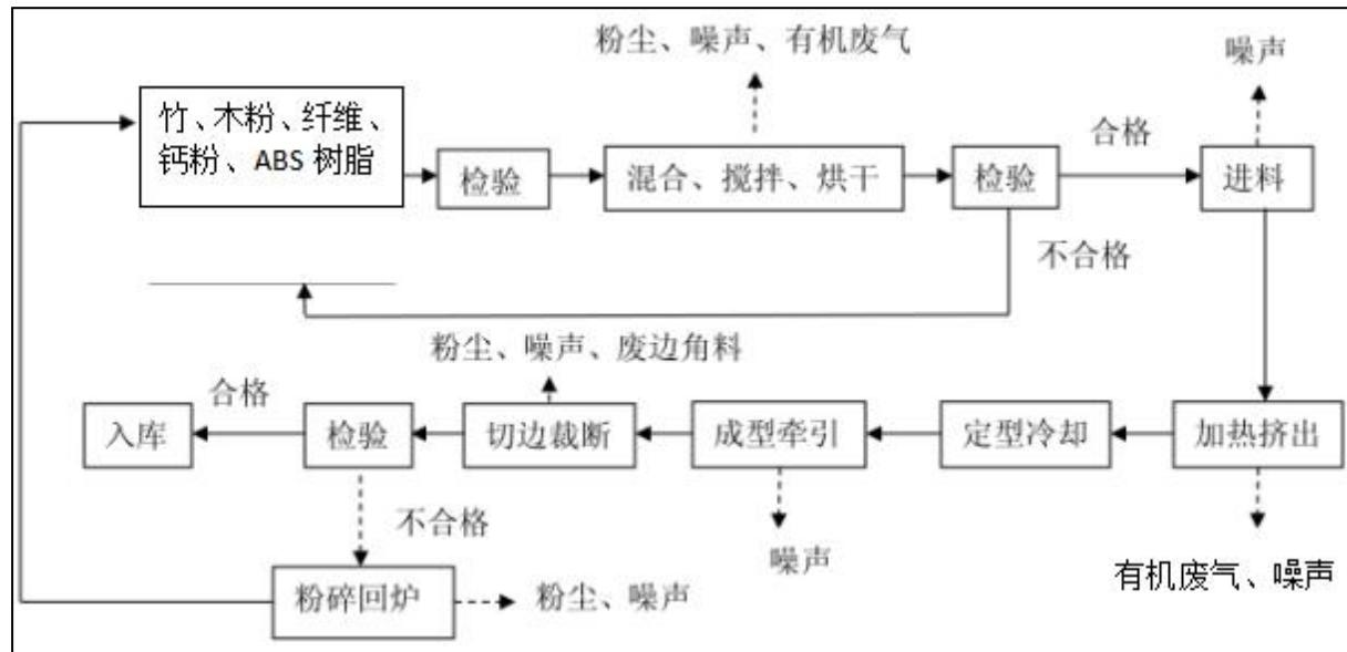
图 4.3-2 竹木纤维维护墙板生产工艺图
