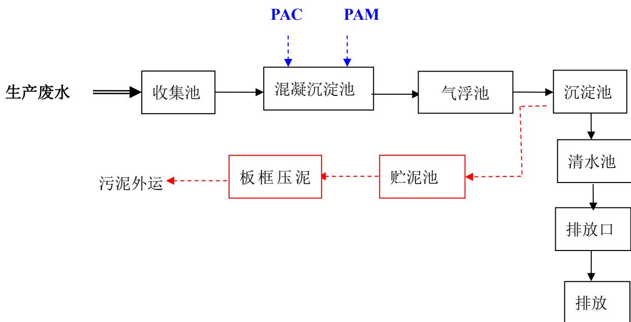
图 8.2-1 生产废水处理工艺流程图
