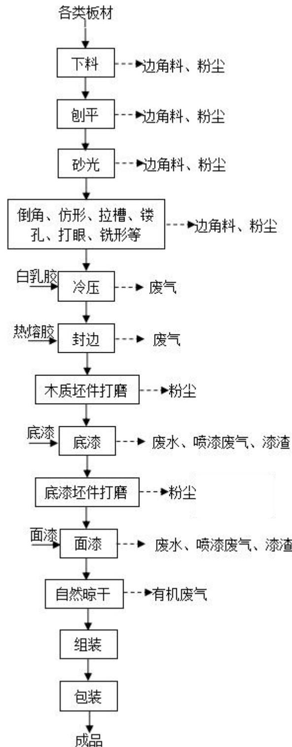
图 4.4-1 生产工艺流程图
