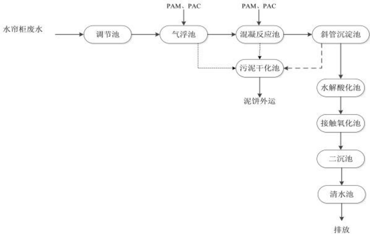
图8.2-1 污水处理站废水处理工艺流程图
