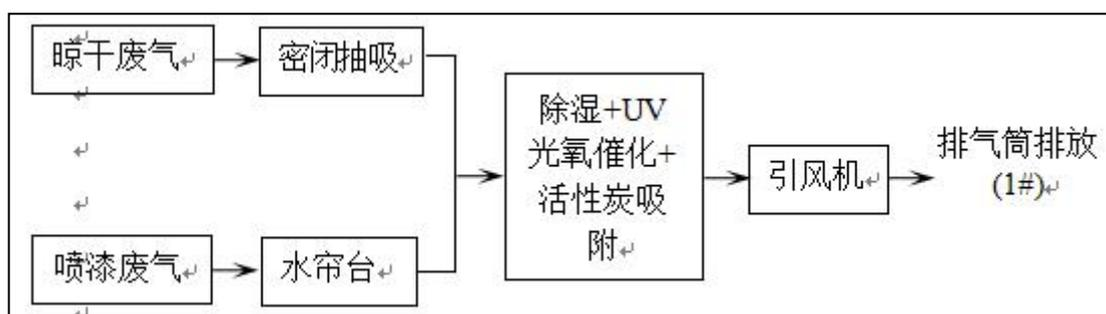
图 8.2-2 涂装废气处理工艺图
