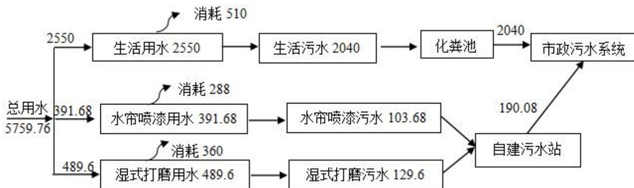
图 4.5-1 项目水平衡图 (单位:  $\text{m}^3/\text{a}$ )
