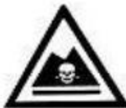
图 9.2-4 危险废物贮存场所警告图形标志
