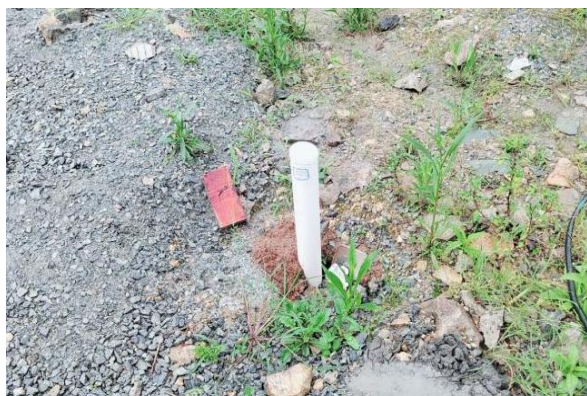
地下水监控井
